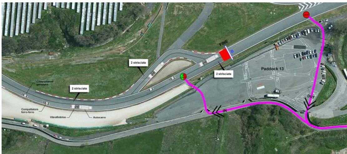
Figura 90: posa del tappeto di usura nel terzo tratto del lotto 1
