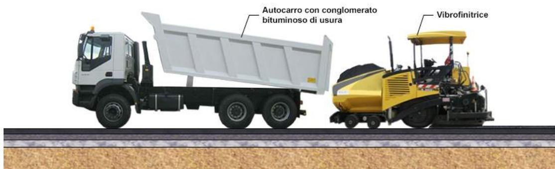
Figura 68: posa di 4 cm di tappeto d'usura con vibrofinitrice
