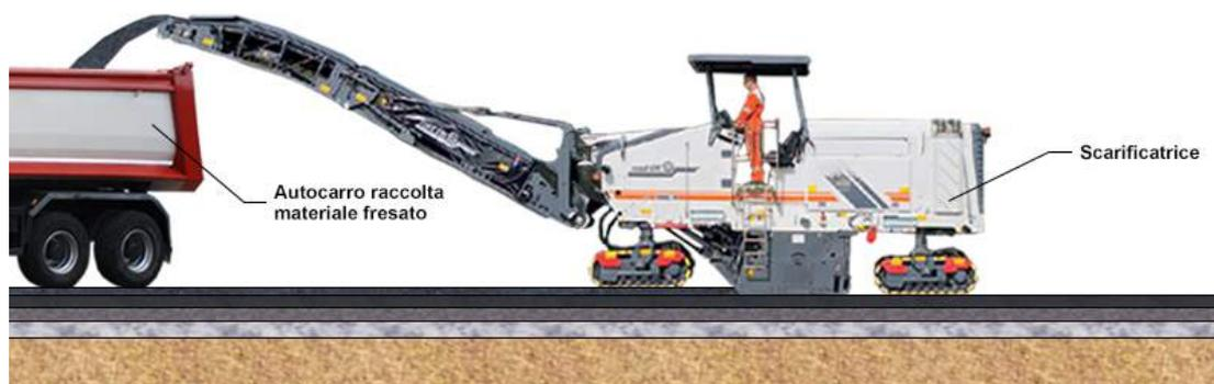
Figura 94: scarifica e raccolta del materiale fresato
