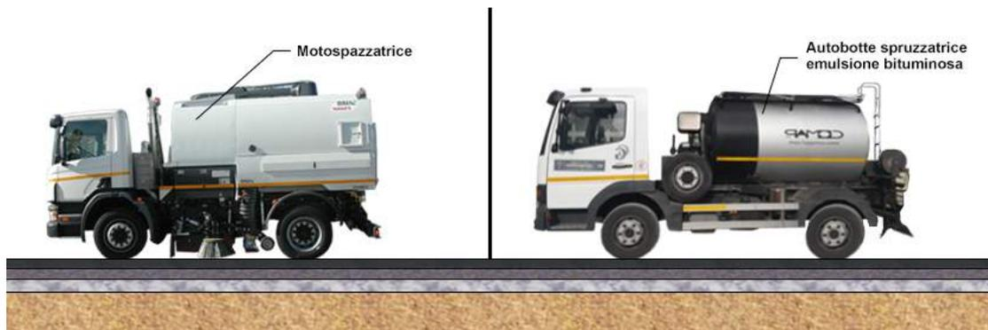
Figura 67: pulizia con motospazzatrice e stesa di una mano d'attacco in emulsione bituminosa
