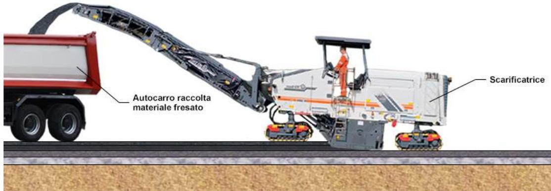
Figura 66: scarifica e raccolta del materiale fresato
